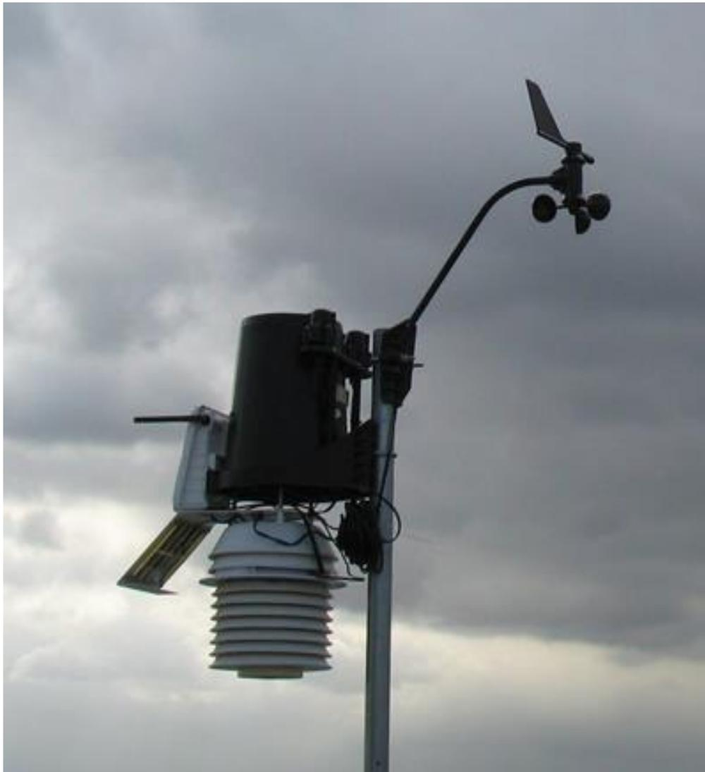
En la siguiente se muestra la estación meteorológica “DAVIS VANTAGE PRO2 6152” utilizada en el análisis.
