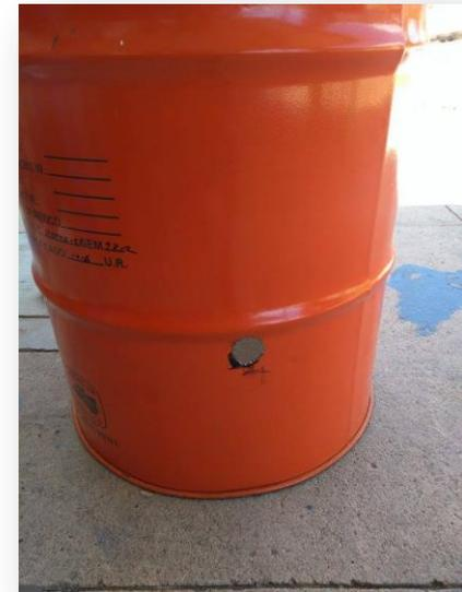
Orificio de la entrada de agua caliente
